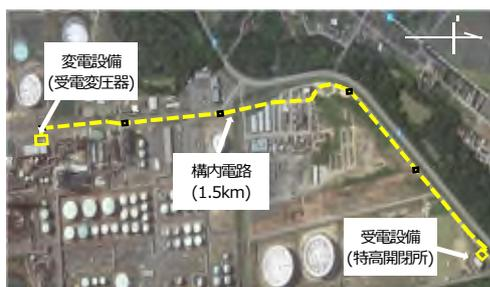
図1 受電設備配置図
