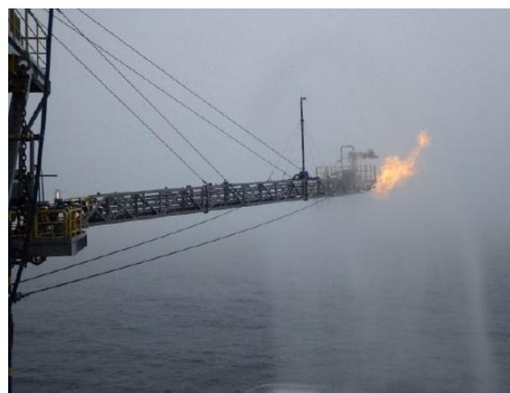
図-2：産出テストによるガス燃焼状況
