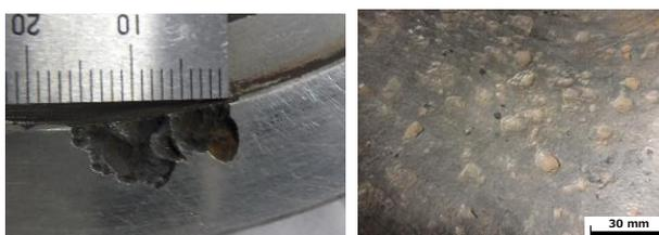
Fig.1 逆止弁腐食状況(左: SUS403, 右: FCD-S)
