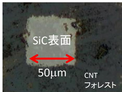
Fig. 2 パターニングした領域の光学顕微鏡像
