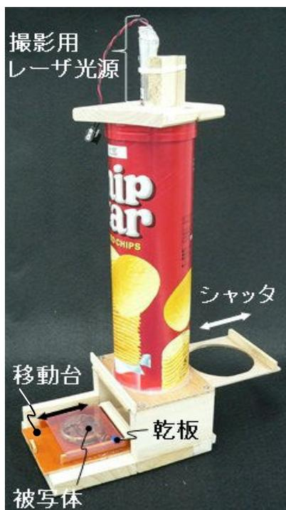
図1 露光装置
