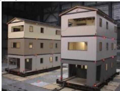
図-1 実大振動台実験 (左：試験体1、右：試験体2)
