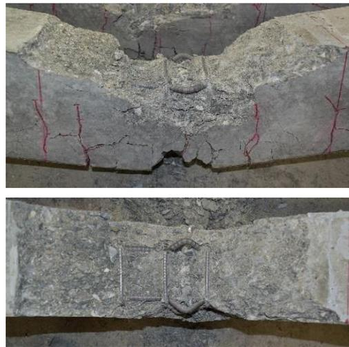
写真-1 RC はりの破壊性状
