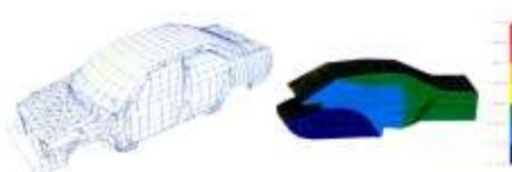
図4 車体構造振動 (左) 及び音場モデル (右)
