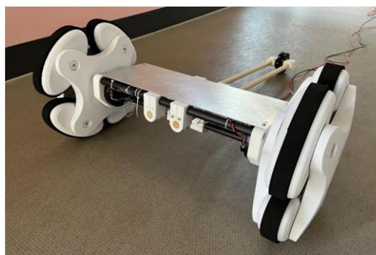
図-5 階段昇降ロボットの試作機
