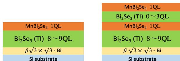
図：磁性トポロジカル絶縁体ヘテロ構造（左）とサンドウィッチ構造（右）の模式図
