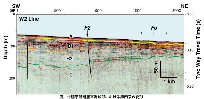
F2 断層は上部更新統(B1 層) および中部更新統(B2 層) を累積的に変位させる。完新統(A 層) の変位は確認できない。Fo 背斜は F2 断層に伴う断層関連褶曲と判断される。
